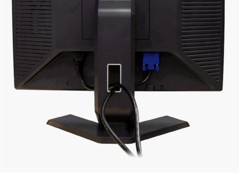
在連接所有必要的纜線至顯示器和電腦後，(參見 [連接顯示器](#) 以取得詳細說明)，可使用連接線孔洞來整理纜線，如上所示。
